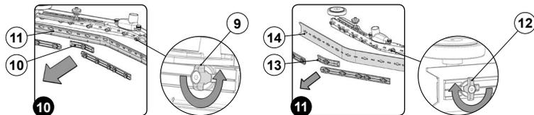
Verificare lo stato d'usura della gomma posteriore del corpo del tergipavimento, se lo spigolo della gomma che è a contatto con il pavimento è rovinato, procedere con la sostituzione (è comunque possibile girare la gomma sui quattro spigoli) effettuando le seguenti operazioni:
